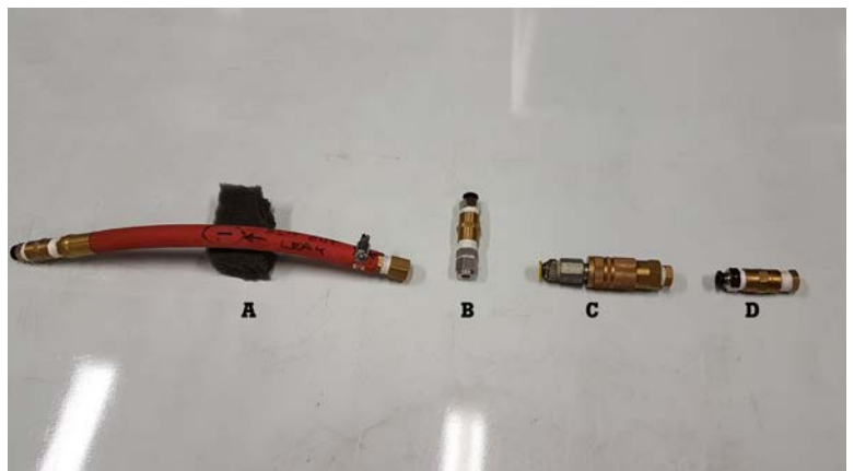
그림 5: 실험 중에 조사한 네 가지 누출 유형은 호스(a), 오픈 엔드(b), 빠른 연결(c), 나사식 커플링(d)입니다.
