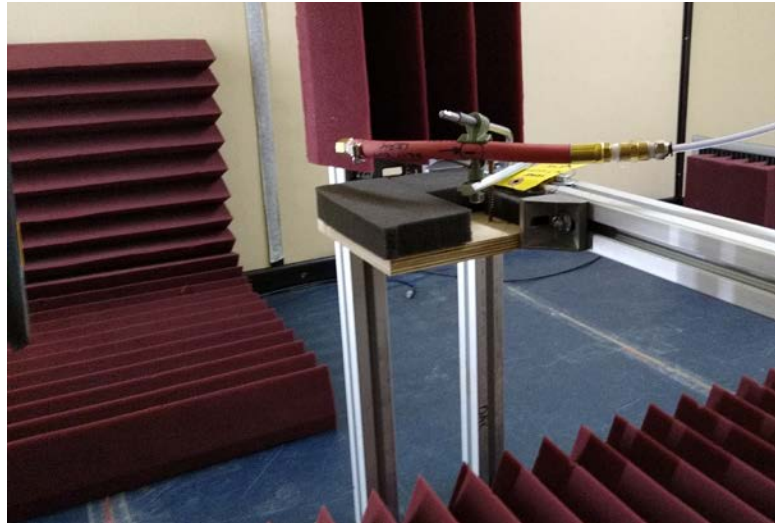
그림 3: 호스 누출 유형은 30도 각도로 측정됩니다.
