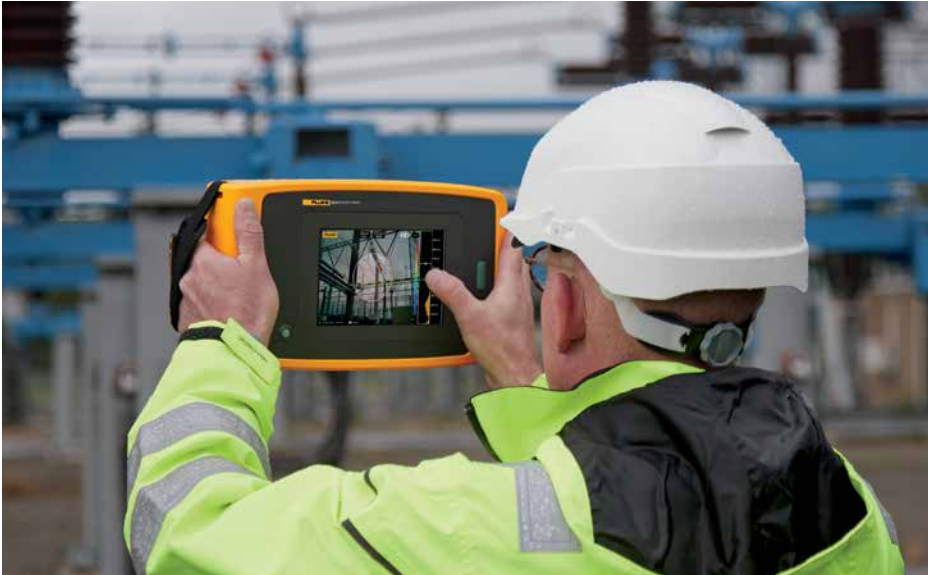
ii910 정밀 음향 이미저가 고전압 응용 프로그램에서 부분 방전을 감지하는 것을 촬영한 이미지
